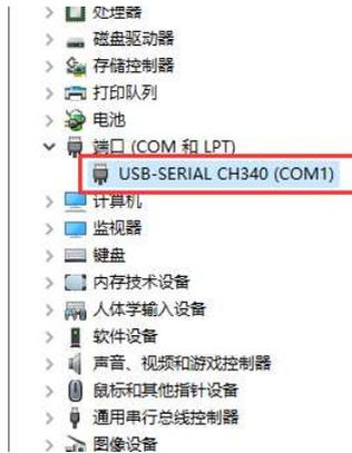
安装固件升级工具，打开固件升级工具，选择端口号码为设备管理器中的端口号“COM1”，其余设置不变。
