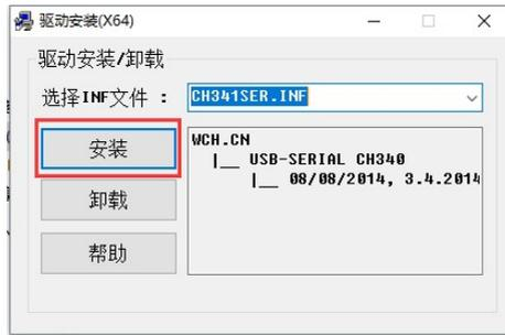
驱动安装成功后可以在电脑设备管理器中端口项目下看到新的 USB 设备，记下括号中的端口号码，例如“COM1”
